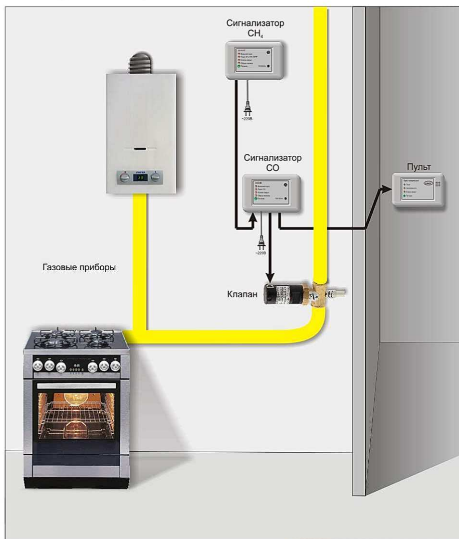
Система автоматического контроля загазованности САКЗ-МК-2-1 (бытовая). Типовая схема размещения
