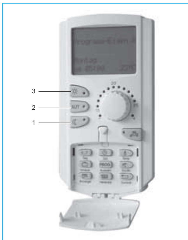
102/2 Переключение режимов работы на пульте управления MEC2
