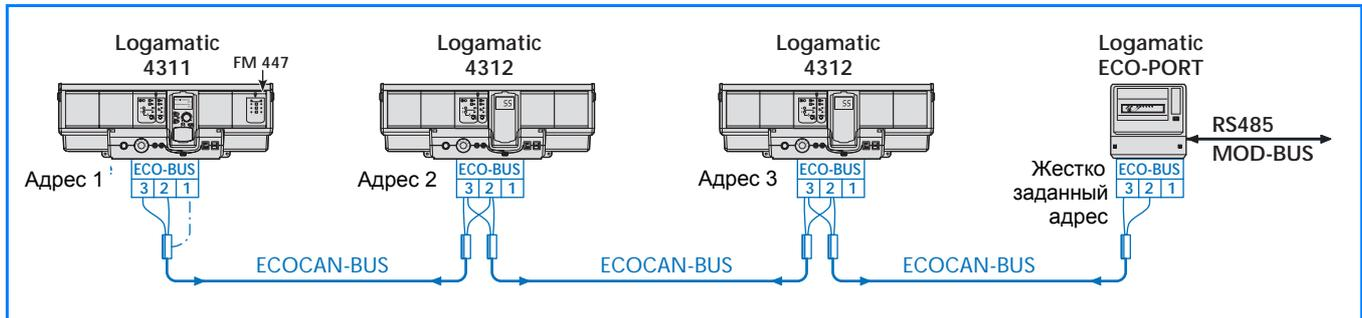
**37/1** Пример сочетания коммуникационного порта Logamatic ECO-PORT на шине ECOCAN с системами управления Logamatic 4311 и 4312 для отопительной установки с несколькими напольными котлами
