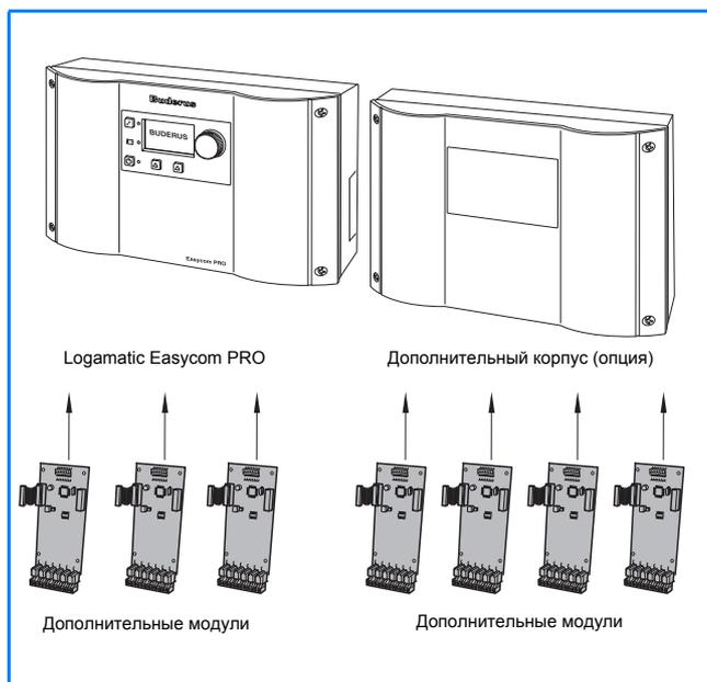
**16/1** Easycot PRO базовый прибор (слева) с 3 свободными разъемами и дополнительным корпусом (справа) с 4 свободными разъемами для модулей
