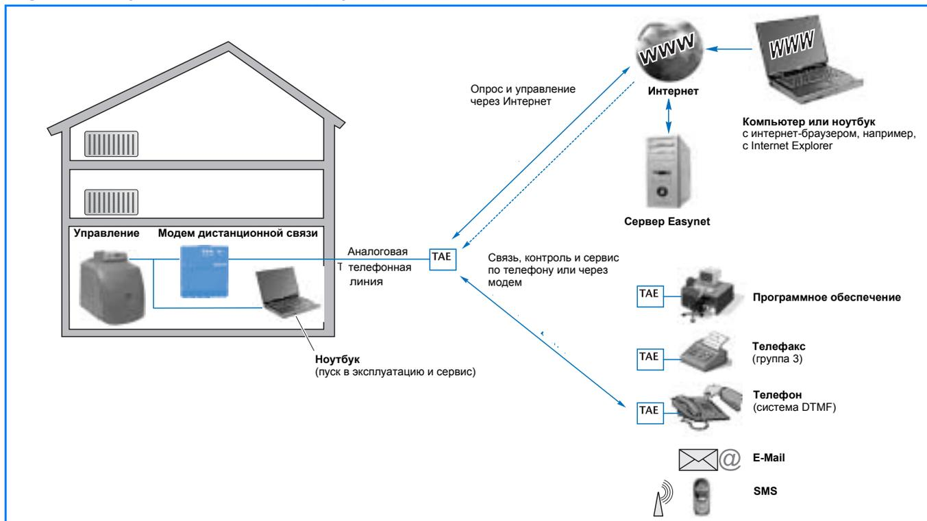
**10/1** Возможности управления, контроля и сервиса отопительной установки через модем дистанционной связи Logamatic Easycom
