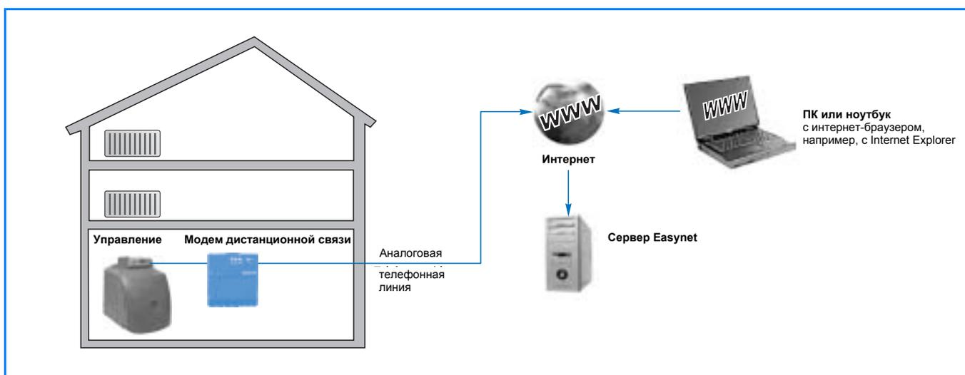
4/2 Установка с модемом дистанционной связи Logamatic Easycot или Easycot PRO: дистанционное управление основными функциями через Интернет („Buderus Easynet“). Модем дистанционной связи соединяет отопительную установку с Интернетом. Сервер Easynet является интернет-сервером, который выполняет соединение с отопительной установкой после проверки права доступа. Описание Easynet → стр. 33.
