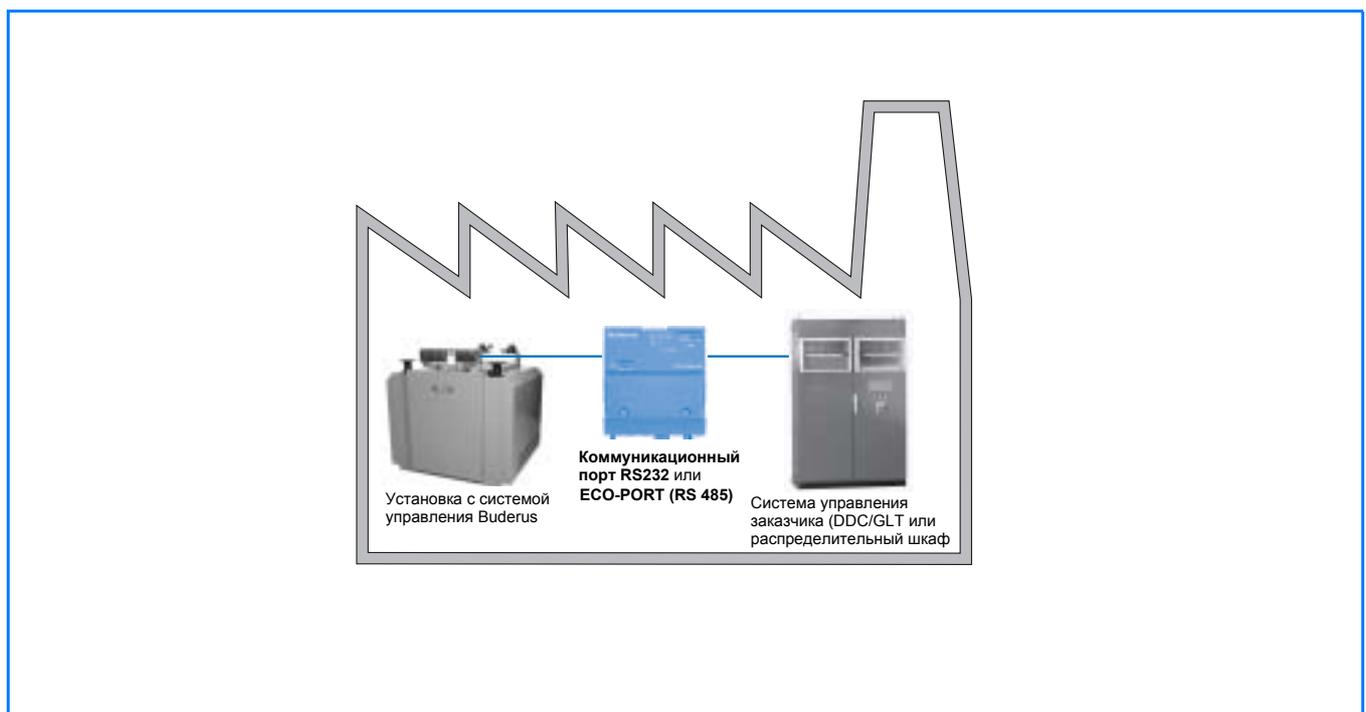
**6/1** Установка модема дистанционной связи в нескольких контролируемых объектах: рабочие сообщения и сообщения о неисправностях, а также записи данных из буферной памяти дистанционного модема передаются на компьютер с программным обеспечением ECO-MASTERSOFT (→ стр. 31).
