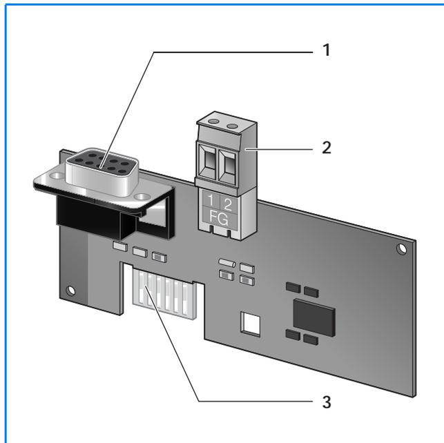
**34/3** Коммуникационный модуль KM271 с разъемом RS232 как дополнительная комплектация для системы управления Logamatic 2107 (или для Ecomatic HS 2105)
