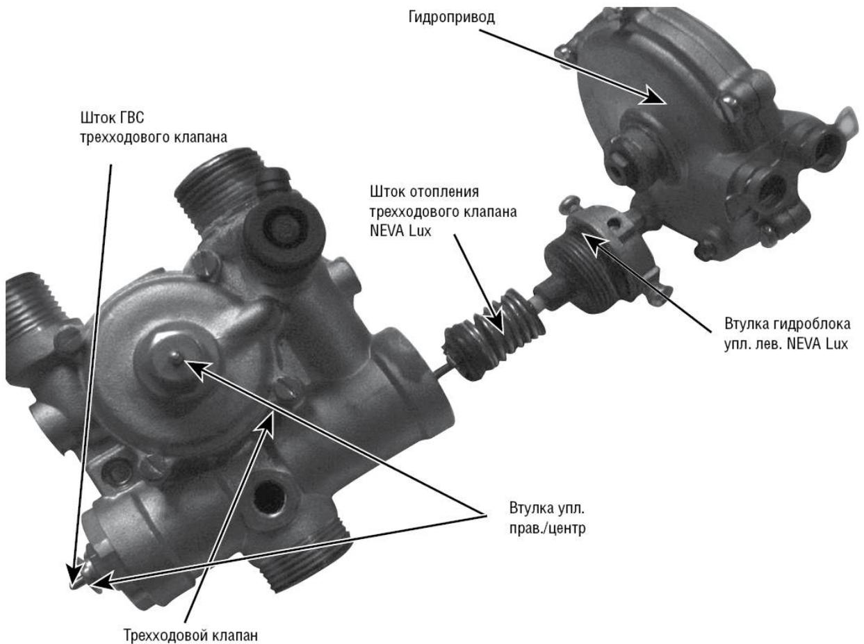
Изображение составных частей гидроблока для модернизированных котлов «NEVALUX- 8023», «NEVALUX-8029»
