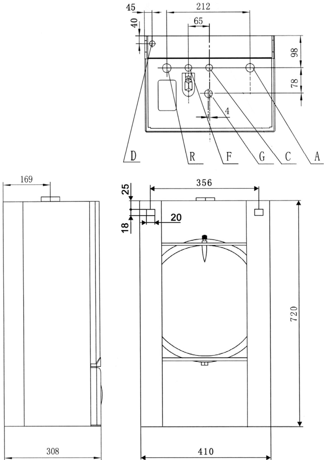
A - выход контура отопления G3/4; C – выход контура ГВС G1/2; G - вход газа G3/4; F - вход холодной воды G1/2; R - вход контура отопления G3/4 (обратка); D – сбросная трубка предохранительного клапана  $\varnothing$  12 мм.
