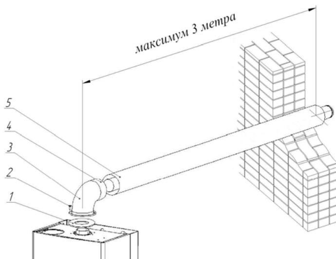
1 - Прокладка  $\text{Ø } 80 \times 125$  мм; 2 - Винт с резьбой; 3 - Коаксиальное колено  $90^\circ$ ; 4 - Уплотнительная полоска из алюминиевой фольги; 5 - Коаксиальная труба:  $\text{Ø } 100$  мм – забор воздуха для горения;  $\text{Ø } 60$  мм – отвод продуктов сгорания.
