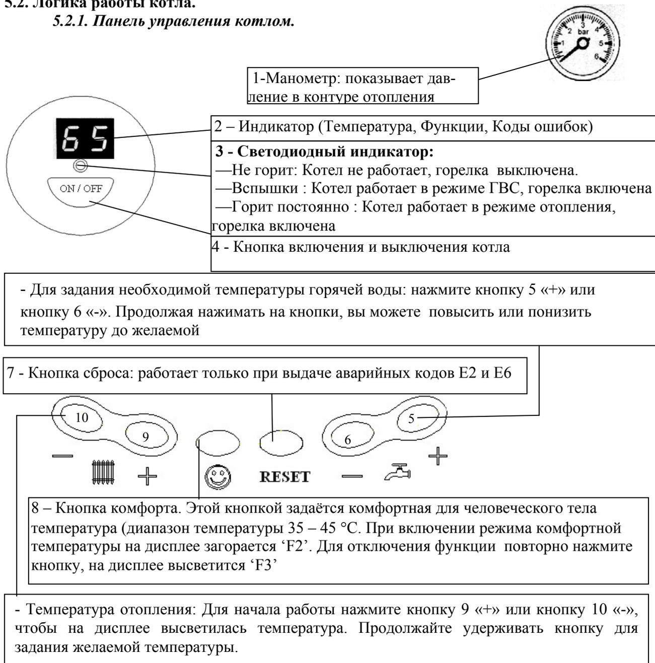
**Рис.5 Панель управления котлом**
