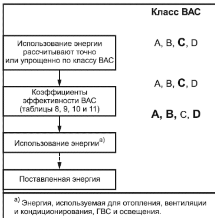
Рисунок 2 - Последовательность расчетов методом коэффициента эффективности ВАС, расчетные классы выделены
